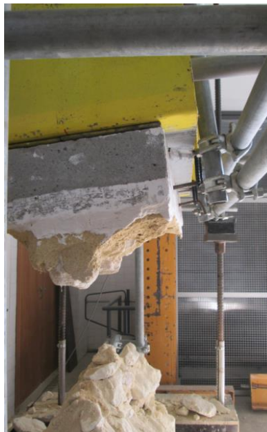
Fig. 4.28 – Viga metálica obstruída pela estrutura metálica do pórtico.
