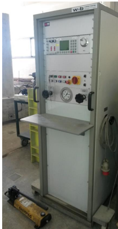
Fig. 4.16 – Bomba hidráulica associada ao cilindro hidráulico da ENERPAC (modelo CLRG-3006) e bomba manual da marca ENERPAC.
