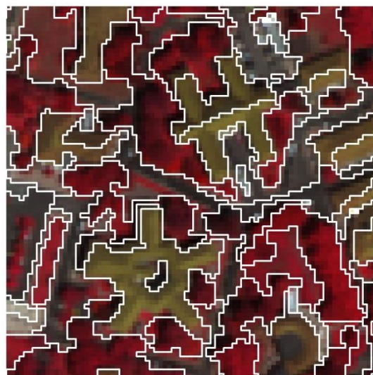
Resultado da Segmentação com scale 30 orientada por objectos ( eCognition 8.0 )
