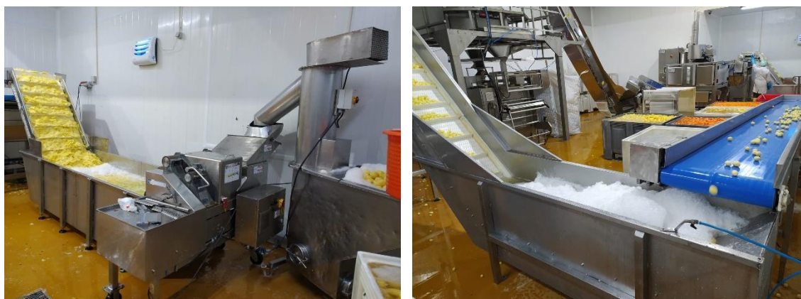
Figura 1.5 – Zona de alto cuidado do processamento da batata. (A) Máquina de corte e tanque de tratamento antioxidante da batata cortada. (B) Tanque de tratamento antioxidante da batata inteira.
