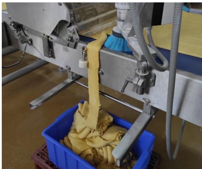
Figura 3.9 - Produção de excedente excessivo na zona de corte
