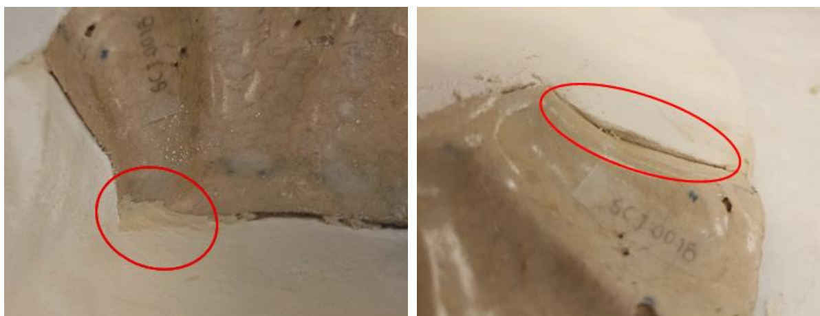
Figura 2.3.a) Reajuste da união com pasta de moldar; b) Excesso de preenchimento
