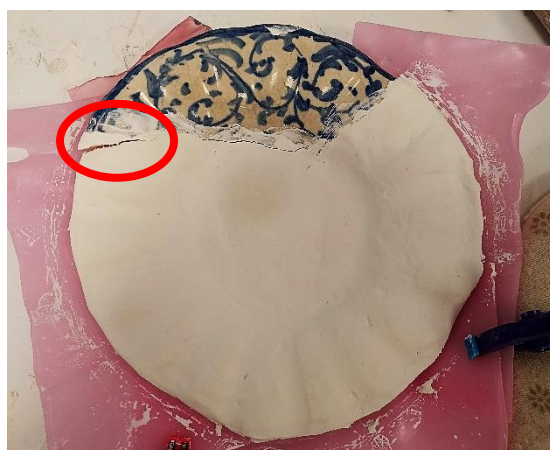
Figura 2.2 - Deformação do preenchimento
