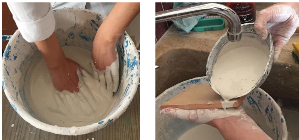
Figura 70 - Processo de vidragem de uma chacota.
