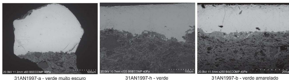
Figura 6. Amostras de três tonalidades distintas de vidrados verdes, observadas por SEM em modo BSE. Os vidrados (parte mais clara da imagem) são homogêneos em todos os casos, embora a amostra 31AN1997-b verde amarelada apresente bolhas e fissuras. Observa-se também que a amostra 31AN1997-a, correspondente ao verde muito escuro, apresenta a camada mais espessa de vidrado.
