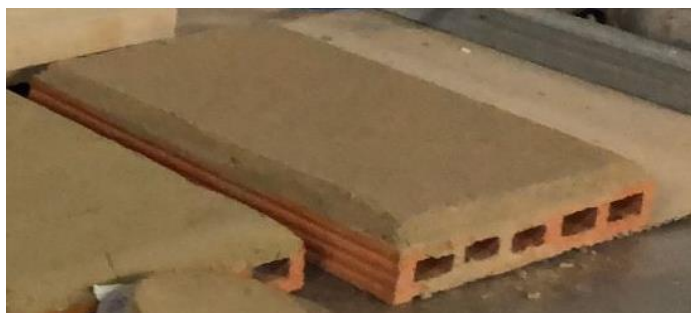
Figura 3.11. Provede de reboco aplicado em tijolo cerâmico (Nascimento, 2024)
