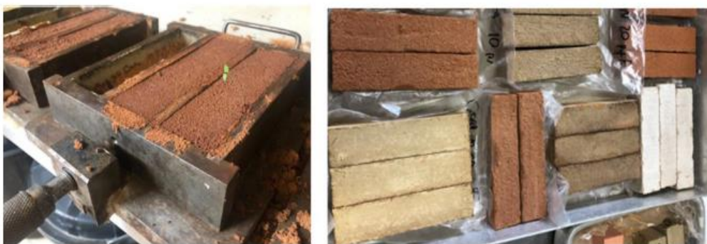
Figura 3.9. Provetes prismáticos nos moldes e desmoldados (Nascimento, 2024)
