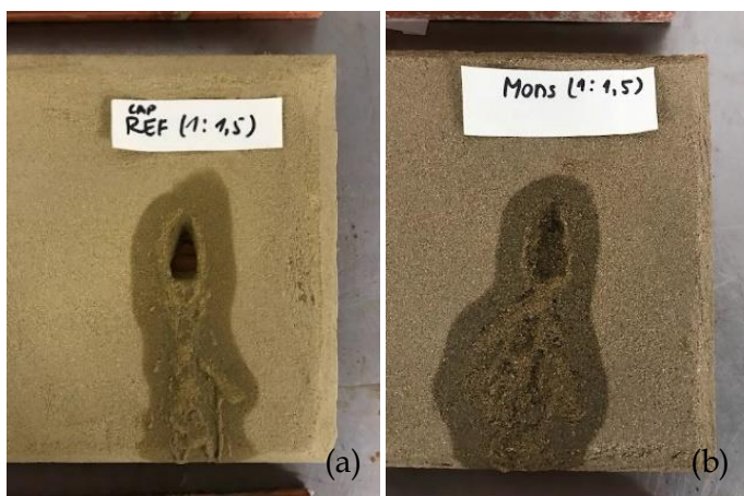
Figura 4.13. Áreas erodidas dos rebocos, CAP(1:1,5)REF (a) e MON(1:1,5)REF (b)
