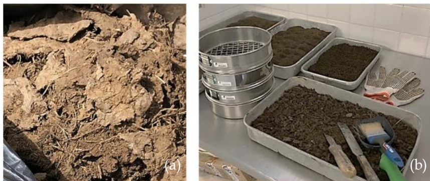
Figura 3.5. Excremento de bovino recolhido seco (a) e desagregado e peneirado (b) (Nascimento, 2024)
