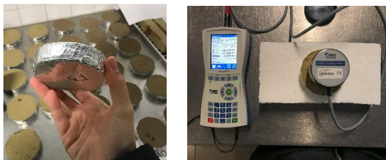
Figura 3.13. Ensaio de condutibilidade térmica nos provetes cilíndricos
