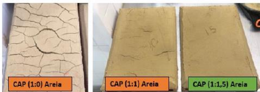
Figura 3.7. Retração de argamassas terra CAP com e sem adição de areia (Pachamama et al. , 2024 a)
