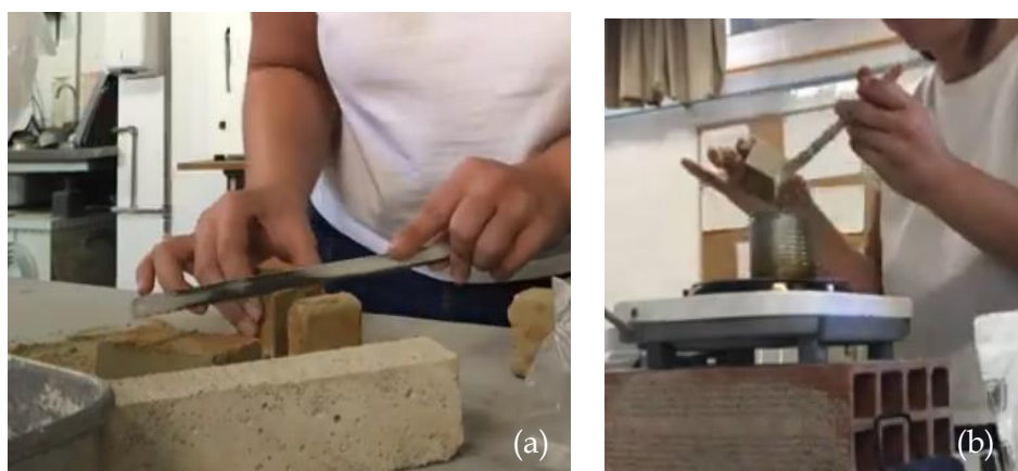
Figura 3.14. Preparação dos provetes prismáticos: (a) corte dos provetes; (b) cera depilatória a ser aplicada nas faces laterais dos provetes
