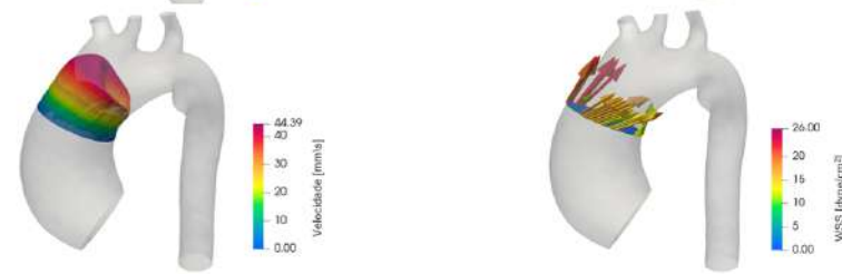
Figura 5.19: Campo vetorial para os parâmetros de velocidade e WSS associados a uma parede com 1mm de espessura, no instante t = 200 ms, para o segundo plano de corte.
