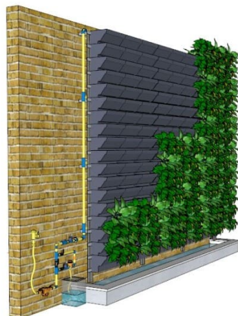
Figura 3.24 – Esquema do sistema de irrigação de uma parede viva modular Fonte: Pinterest, obtido a 9 junho 2021
