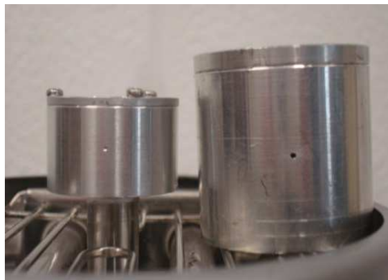
Figura 3.19 Reservatório cilíndrico de 2ª geração, à esquerda, e reservatório cilíndrico de 1ª geração, à direita.
