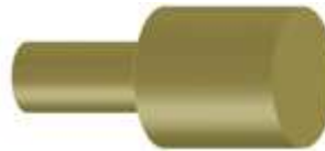
Figura 3.3 Representação, em AutoCAD 2013 , do veio adaptador do motor à polia dentada mandante.
