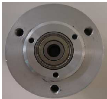
Figura 3.20 Suporte dos rolamentos do veio do reservatório (vista de baixo e sem tampa).
