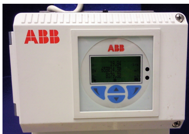
Figura 3.2: Medidor de caudal.
