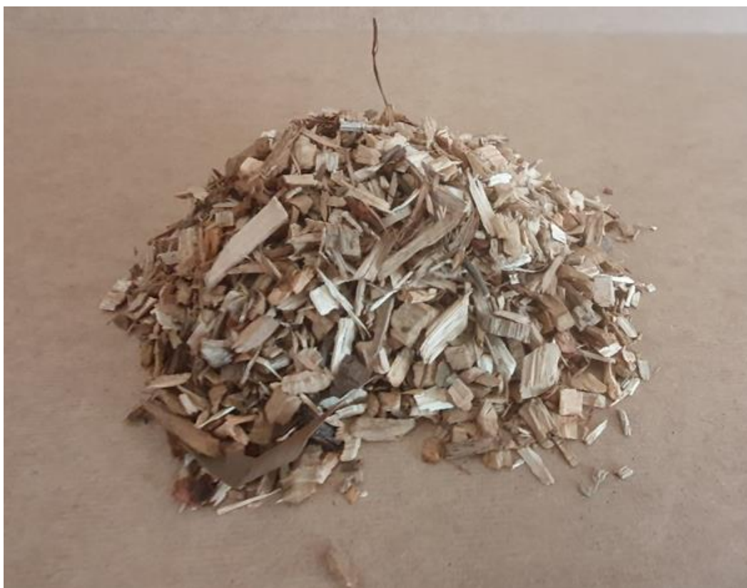
Figura 22 - Aspeto de uma subamostra de micro-estilha fornecida para a realização dos ensaios.
