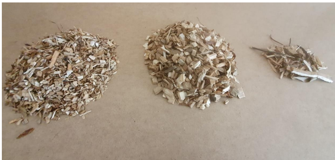
Figura 23 - Aspeto das frações de granulometria 1, 2 e 3 separadas a partir da micro-estilha e utilizadas em ensaios de macro-TGA..
