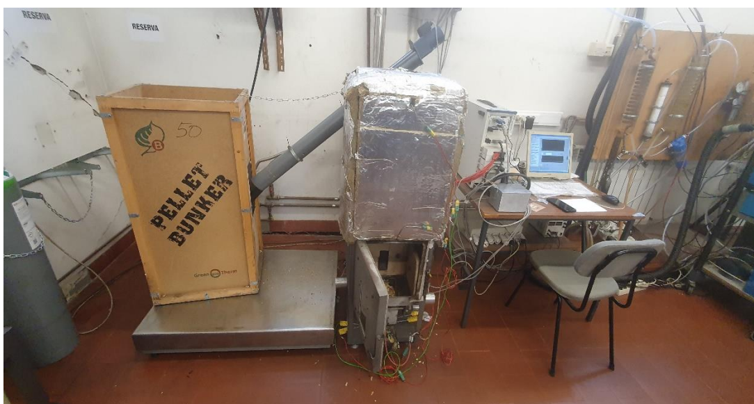
Figura 255 - Aspetto da caldeira laboratorial e sistemas analíticos utilizados nos ensaios de combustão da micro-estilha..
