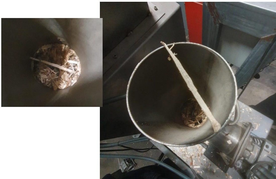
Figura 39 - Origem do encravamento entre a válvula rotativa e o sem-fim horizontal.
