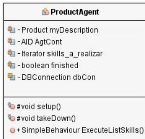
Figura 5.14: Diagrama das Classes que compõem o PA
