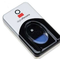
Figura 2.1: Leitor de impressões digitais DigitalPersona U.are.U 4500
