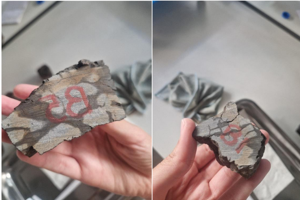
Figura 4.19 - Fraturas visíveis apenas a meio do processo de secagem dos provetes B1 e B5
