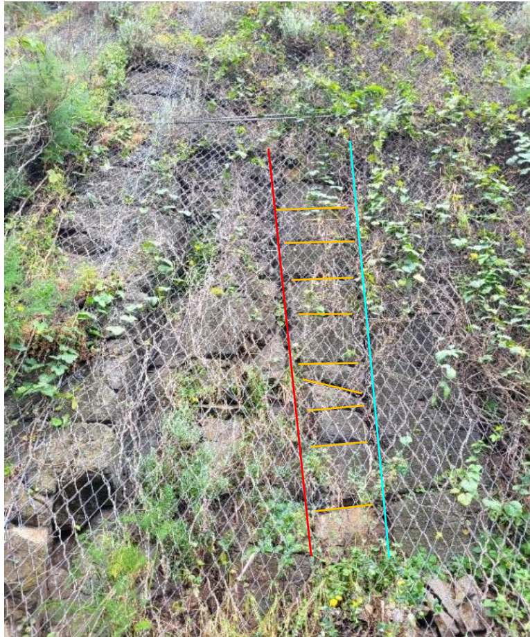
Figura 4.5 - Famílias de fraturas existentes no afloramento do Ponto 3, a vermelho e a azul as famílias subverticais e a laranja a família subhorizontal
