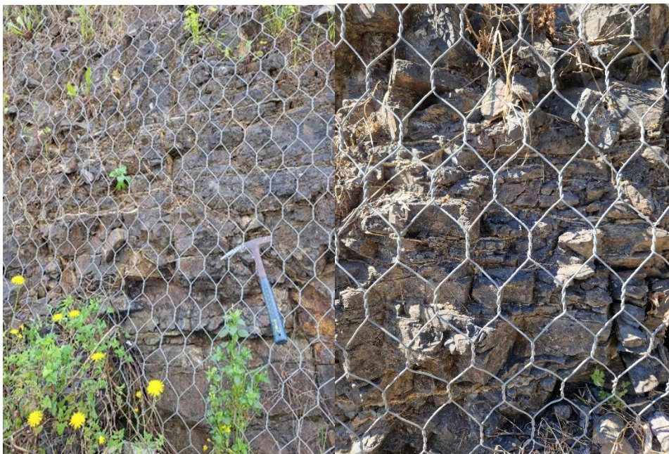
Figura 4.36 - Fraturas subhorizontais preenchidas com cimento carbonatado na zona do basalto
