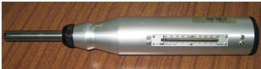
Figura 2.10 - Esclerómetro do tipo Schmidt utilizado para a determinação da resistência da rocha (retirado de FAIM, 2014)
