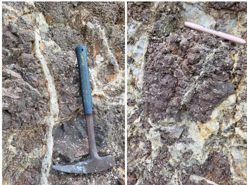
Figura 4.42 - Zona da Brecha Vulcânica do afloramento do ponto 7, com representação de um veio de calcite e blocos de basalto francamente alterado
