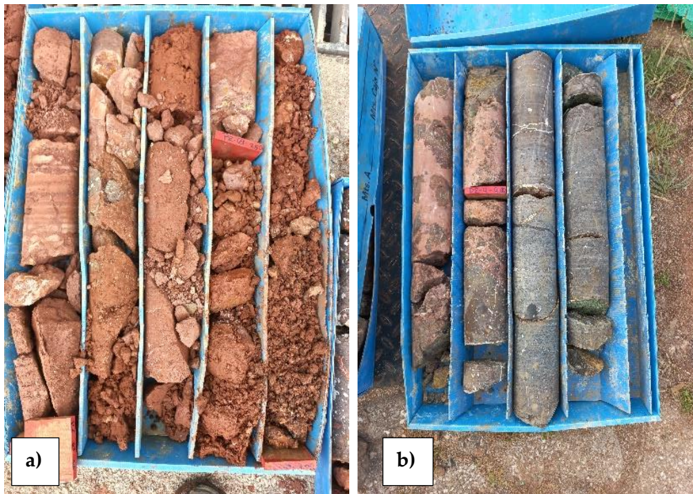
Figura 4.1 - Testemunhos de sondagem correspondentes ao nível dos piroclastos (a) e ao nível das brechas vulcânicas e basaltos (b)
