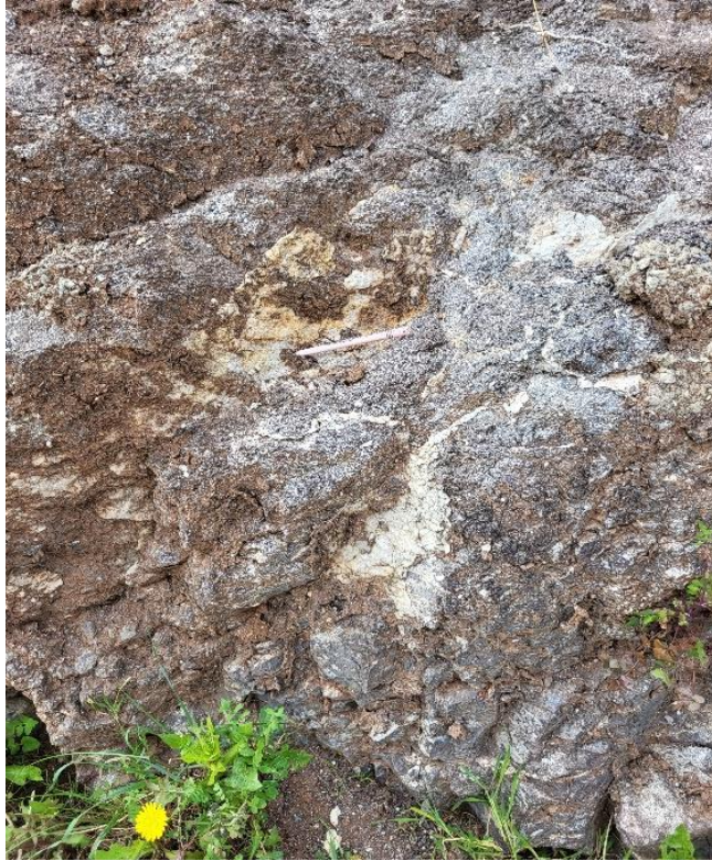
Figura 4.40 - Zona de Basalto francamente alterado e com veios carbonatados com espessura considerável
