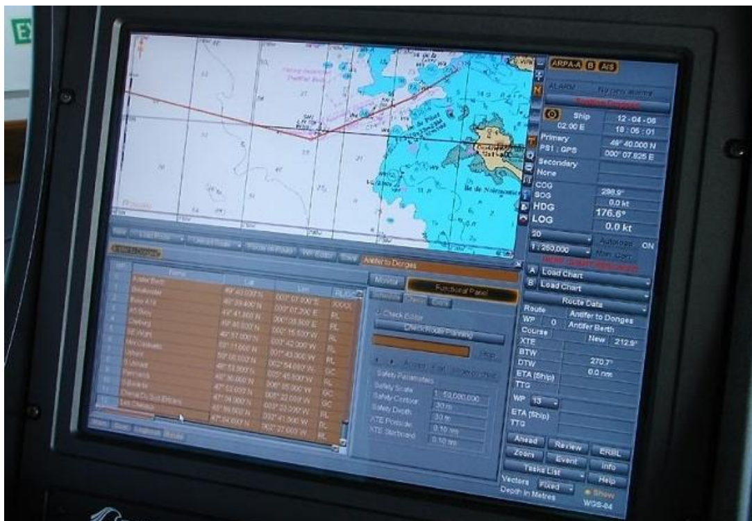
Figura 17 - Fotografia de um ECDIS em funcionamento [Marine insight, 2019]
