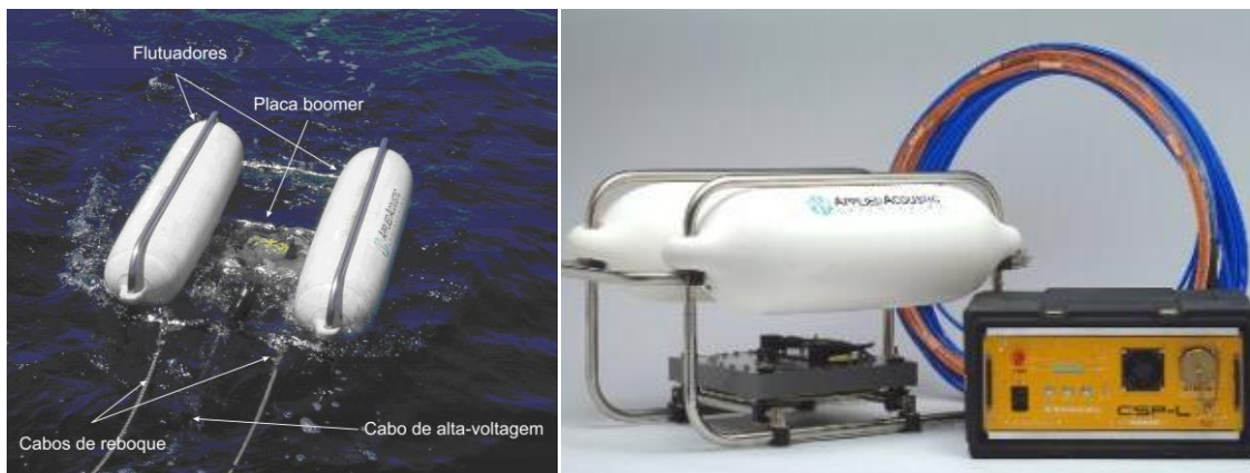
Figura 4.5 - Catamaran com a placa de boomer instalada (IH) e sistema em detalhe (Applied Acoustics Engineering, 2014, online )
