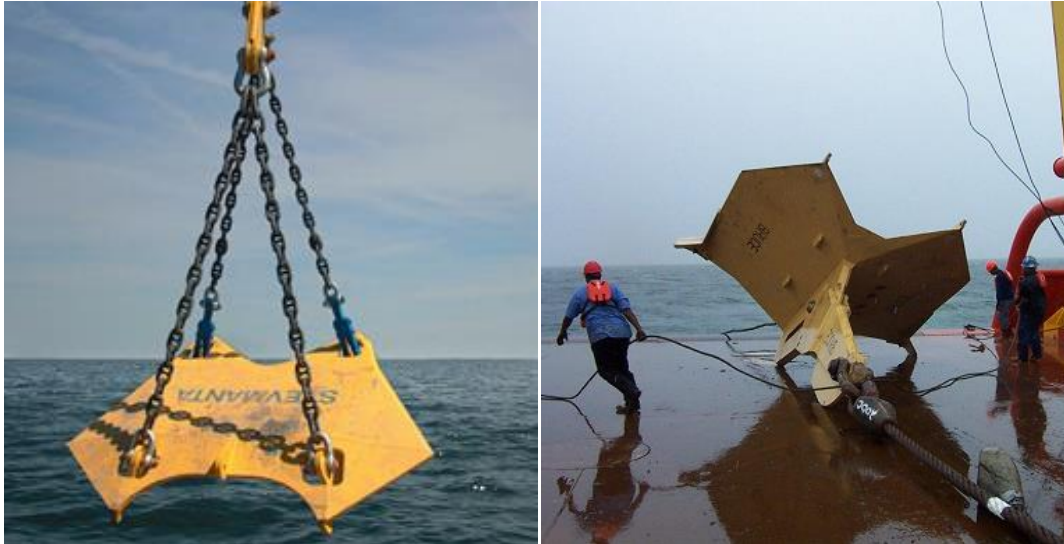
Figura 2.15 – Âncora Vryhof Stevmanta à esquerda (Vryhof, 2014, online ) e âncora Bruce Dennla Mk4 à direita (Bruce, 2014, online )
