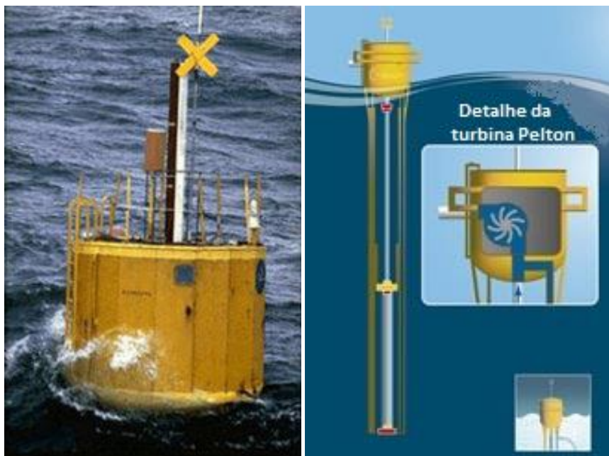
Figura 2.4 – Sistema Aquabuoy (neomansland.info) e respetivo esquema de funcionamento (altenerg, 2014, online )
