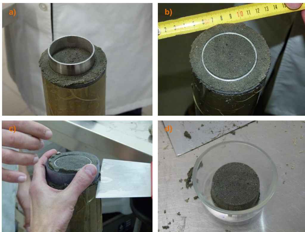
a) início do processo de cravação do anel metálico; b) anel cravado; c) corte do testemunho com 2 cm de espessura; d) provete preparado para os diferentes ensaios
