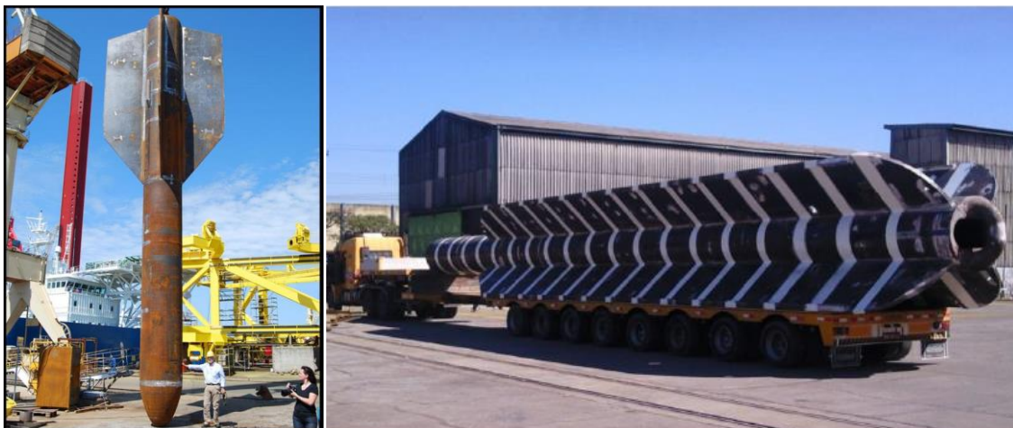
Figura 2.16 – Âncora DPA à esquerda (deepseaanchors, 2014, online ) e âncora torpedo à direita (delp, 2014, online )
