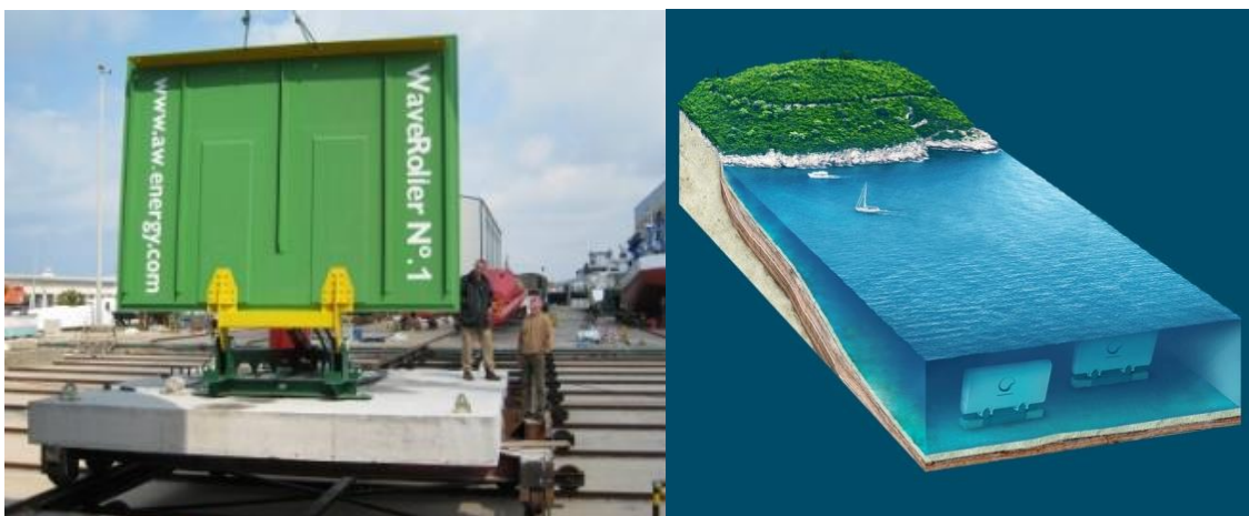
Figura 2.8 – Aspetos de uma das pás do dispositivo Waveroller e esquema destes dispositivos instalados sobre o fundo marinho (aw-energy, 2014, online )
