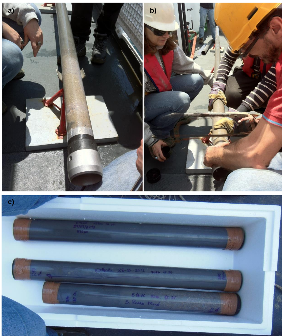
a) Amostra retirada no liner e após extração do tubo de penetração; b) corte testemunho em segmentos menores; c) segmentos da amostra vertical E16VC acondicionados e preparados para armazenamento em arca frigorífica
