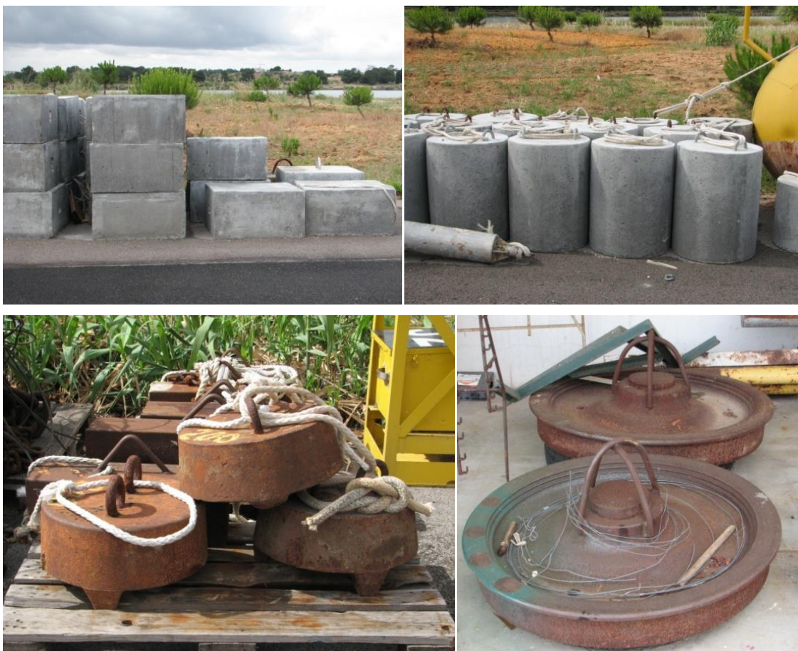
Figura 2.11 – Aspectos de poitas de betão (em cima) e de aço (em baixo)
