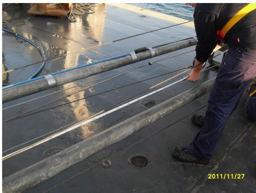
Figura 4.10 – Medição da penetração máxima do tubo do amostrador após a colheita de uma amostra
