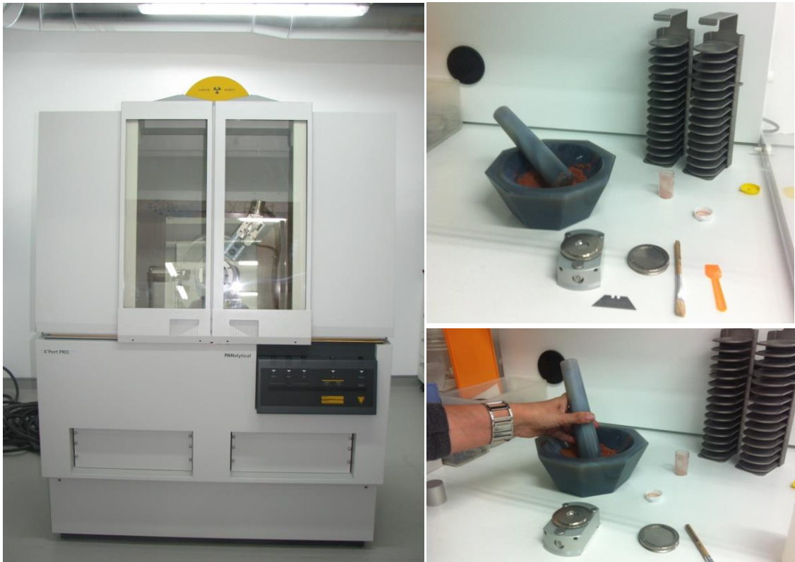
Figura 4.18 – Difrátometro de raios X: modelo X'Pert PRO da PANalytical (esquerda) e aspeto da respetiva preparação das amostras (direita)
