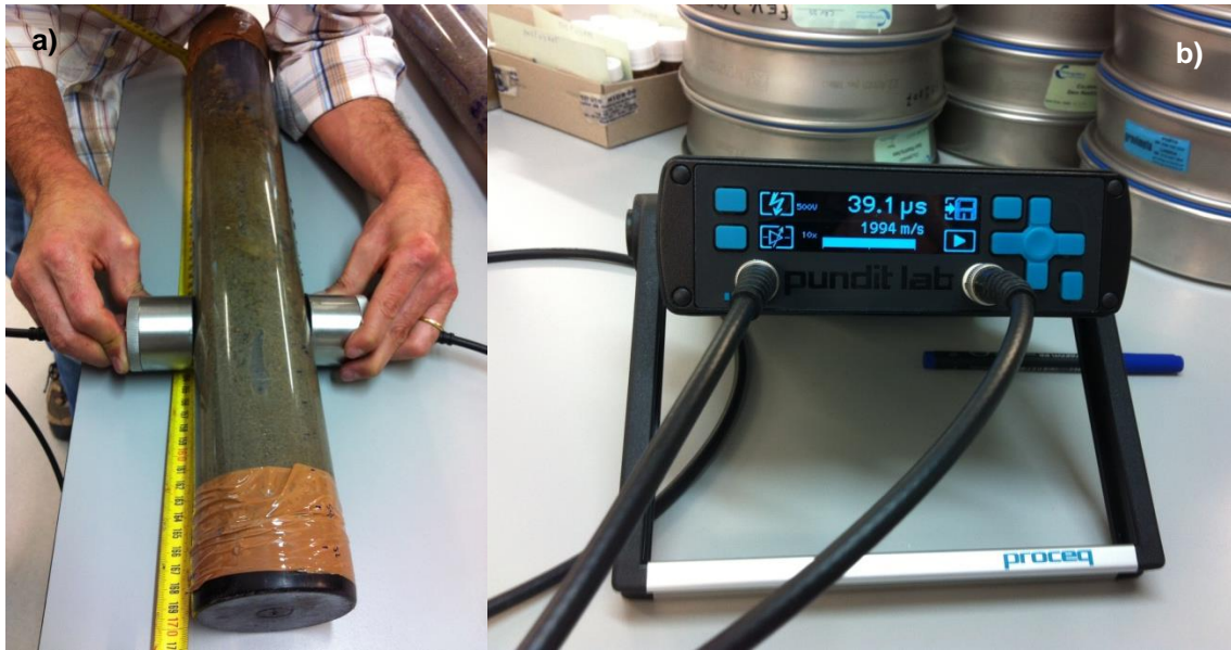
a) pormenor da colocação dos transdutores; b) dados obtidos durante uma medição
