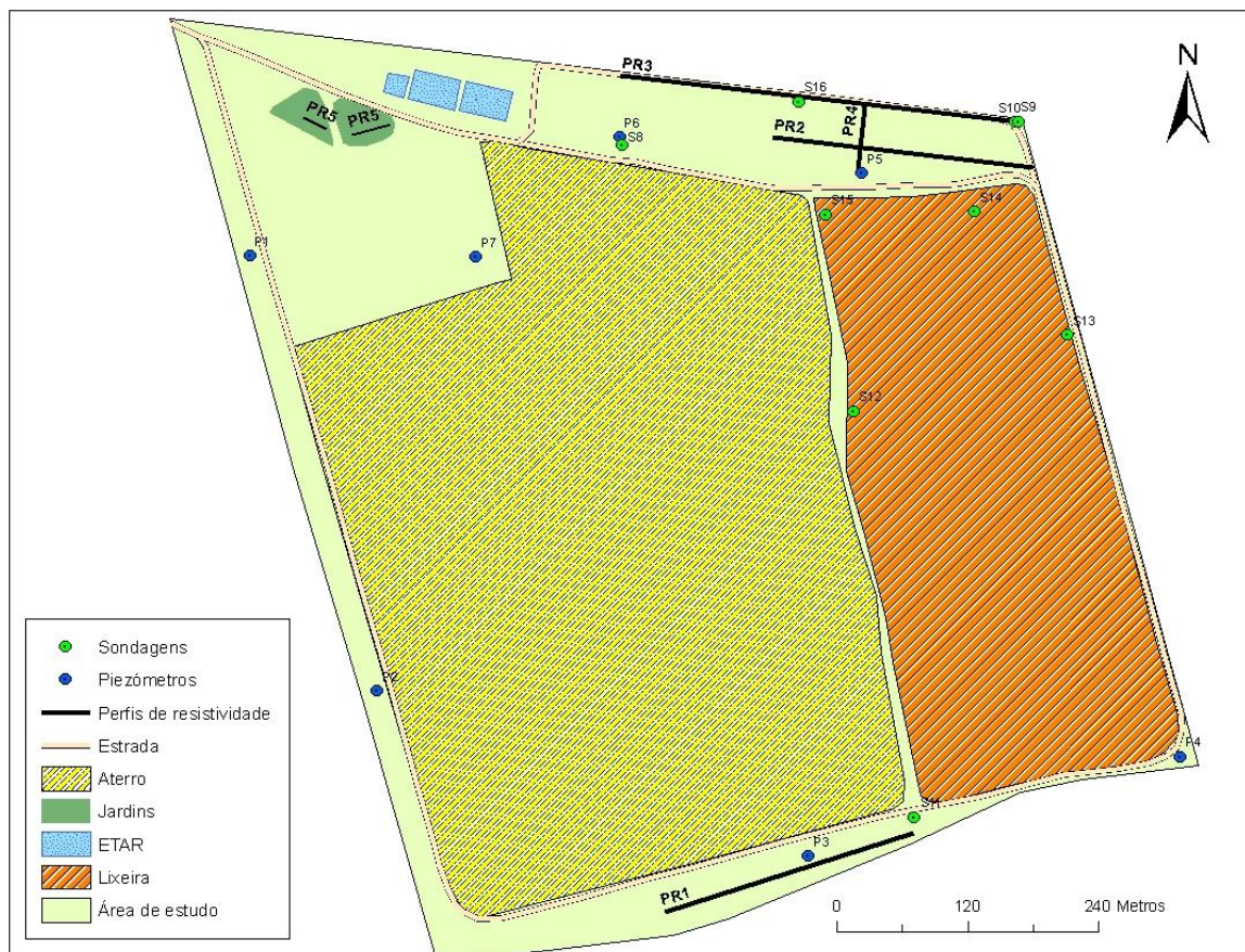
Figura 4.1 - Área de estudo e localização dos perfis de resistividade, sondagens e piezómetros.
