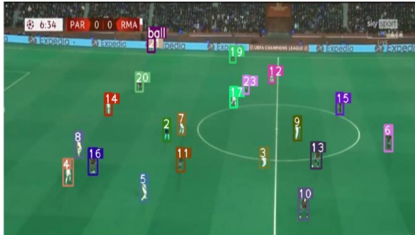
Figura 17 - Exemplo de imagem para o tracking de jogador, bola e equipa utilizando DeepSORT e YOLOv5 (Saseendran et al, 2023)
