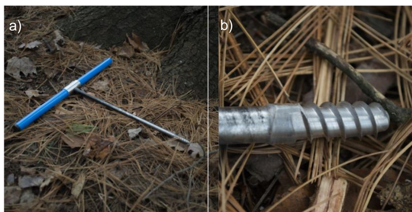
Figura 12: a) Verruma de Pressler; b) Broca (Fonte: https://blog.uvm.edu/jpconsta-dendrochronology/in-the-field/ , consultado em julho de 2023)
