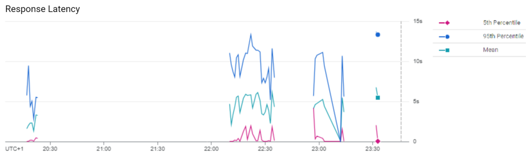
Figura 5.4: Latência das respostas da App Engine - Teste de Carga
