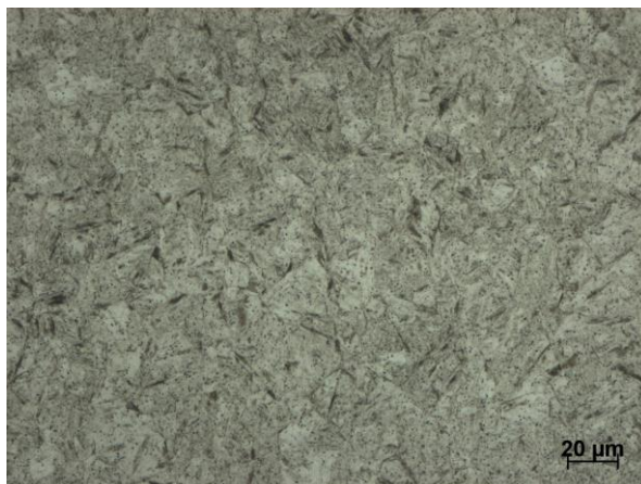
Figura 3.12 – Ataque químico com a solução #110 da norma ASTM E407 durante 40 minutos de imersão. MO-BF 50x
