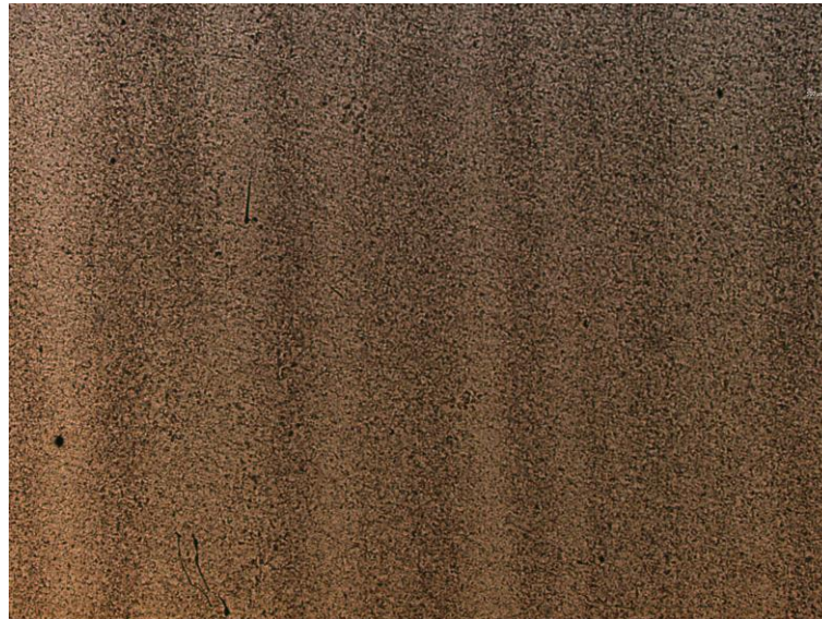
Figura A.16 - Contraste com Peroxodissulfato de Amônio durante alguns segundos com um cotonete. Micrografia original. Objetiva de 5x.
