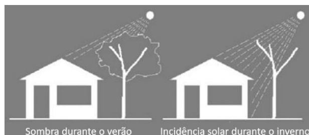
Figura 2.3 - Representação do sombreamento com recurso a árvores de folha caduca. Adaptado de (Dicas de Arquitetura, 2018)
