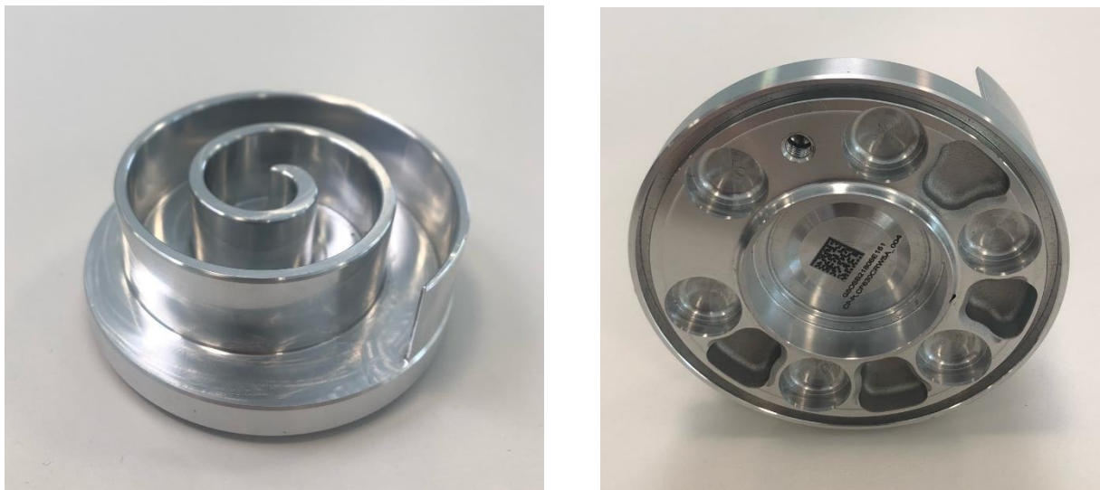
Figura 3.4- Orbiting Scroll após processo de maquinação.
