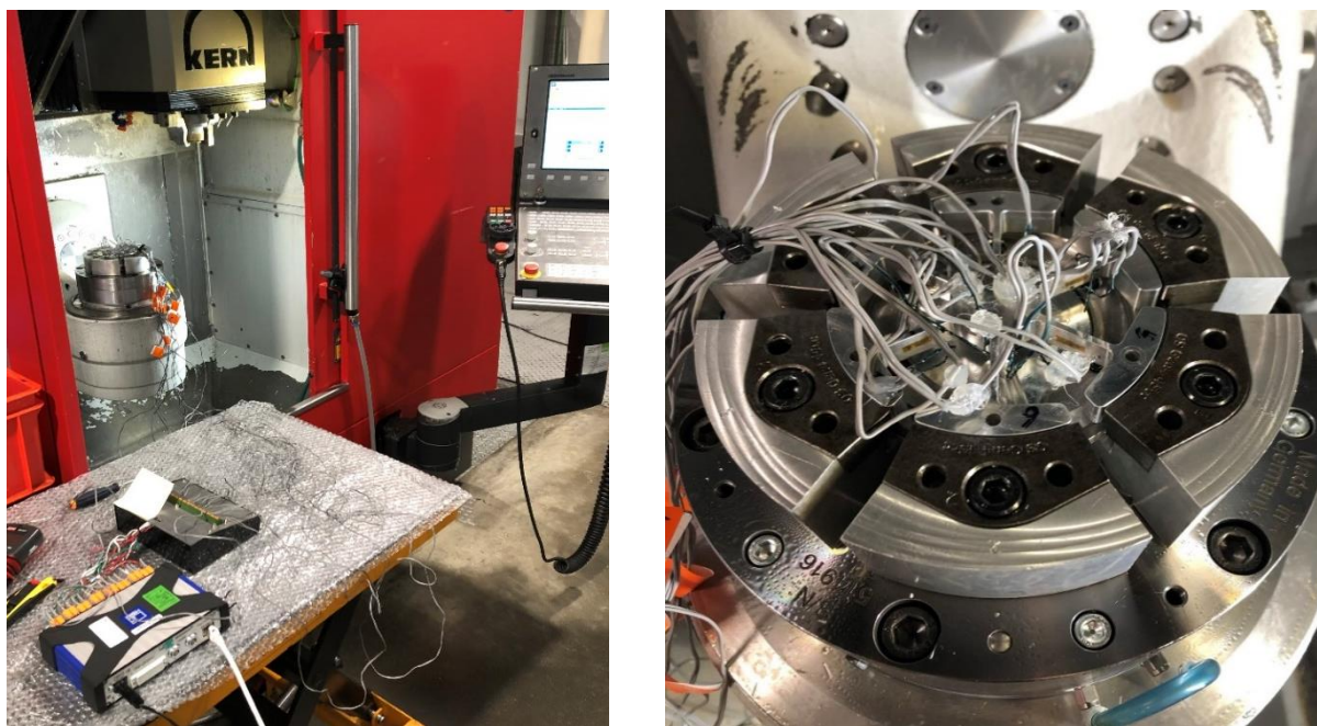
Figura 5.11- Ensaio de medição das extensões (à direita), e posicionamento do dispositivo de medição de forças, na bucha de diafragma (à esquerda).
