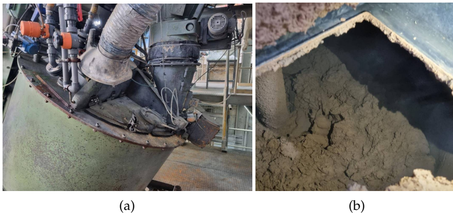
Figura 3.5: Produção de pasta: (a) Amassadora Eirich; (b) Pasta no interior.
