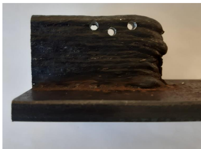
Figura 5.3 - Provette com furos para a inspeção por CI.
