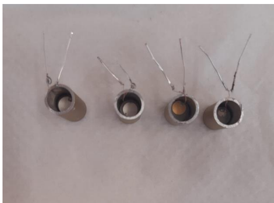
Figura 3.11 - Montagem chassi, calço, piezoelétrico e isolante.
