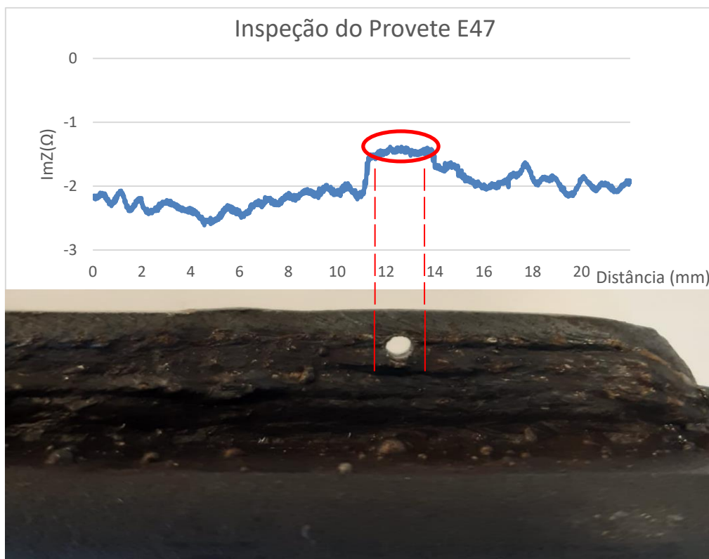
Figura 6.11 - Sinal do ensaio de US a um provete WAAM Hot Forging com um furo.
