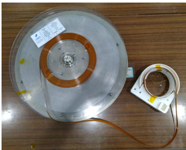
Figura 23 - Processo de enrolamento da fita supercondutora na bobina
