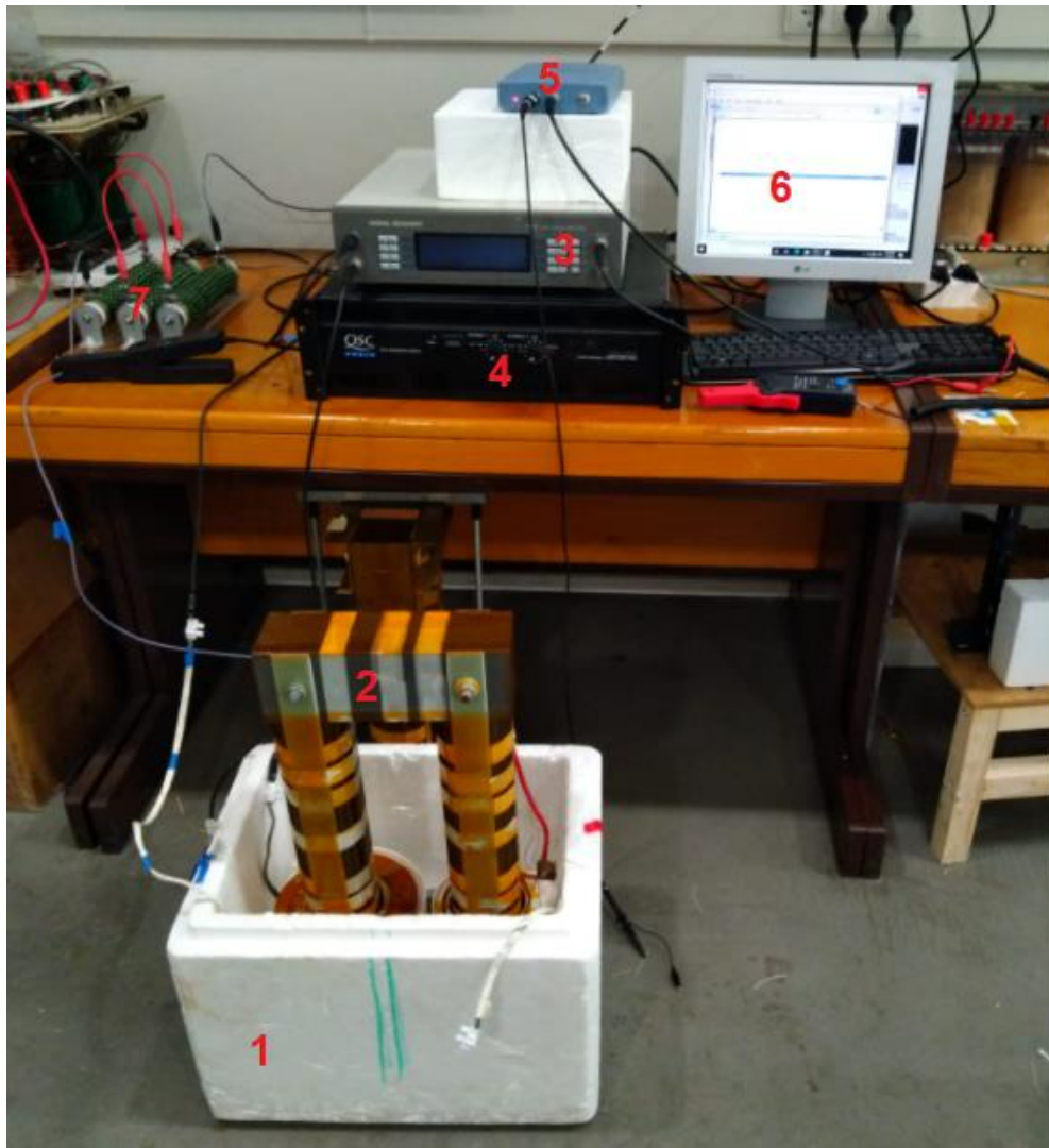
Figura 29 - Montagem experimental para a leitura de resultados: (1) Criostato, (2) Transformador usado, (3) Amplificador Lock-In, (4) Amplificador de Potência, (5) PicoScope, (6) Computador para a recolha de dados, (7) Resistência adicional
