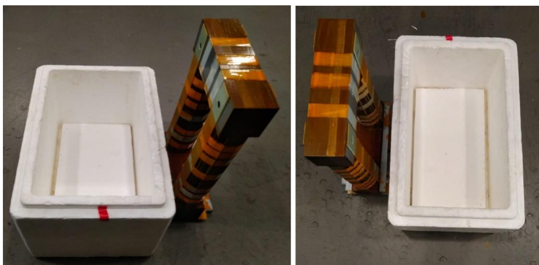
Figura 26 - Comparação do tamanho do criostato com o do transformador usado
