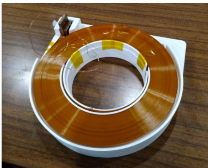
Figura 24 - Molde da bobina primária enrolada com a fita supercondutora
