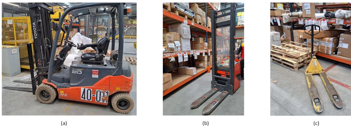
Figura 3.21: Equipamentos de apoio nos Depósitos: (a) Empilhador; (b) Stacker ; (c) Porta-paletes
