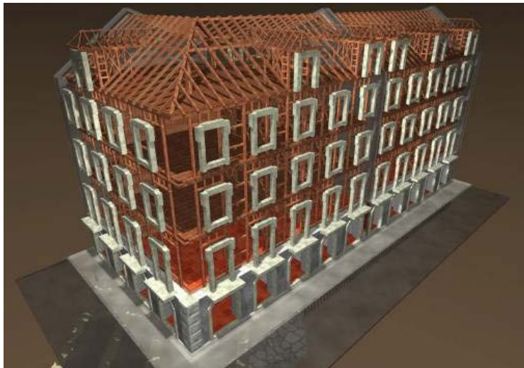
Figura 15 - Modelação em CAD/3D da estrutura Pombalina [21]
