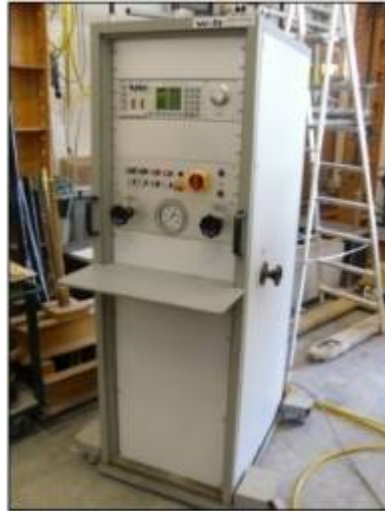
Figura 3.18: Unidade de controlo de pressão [39].
