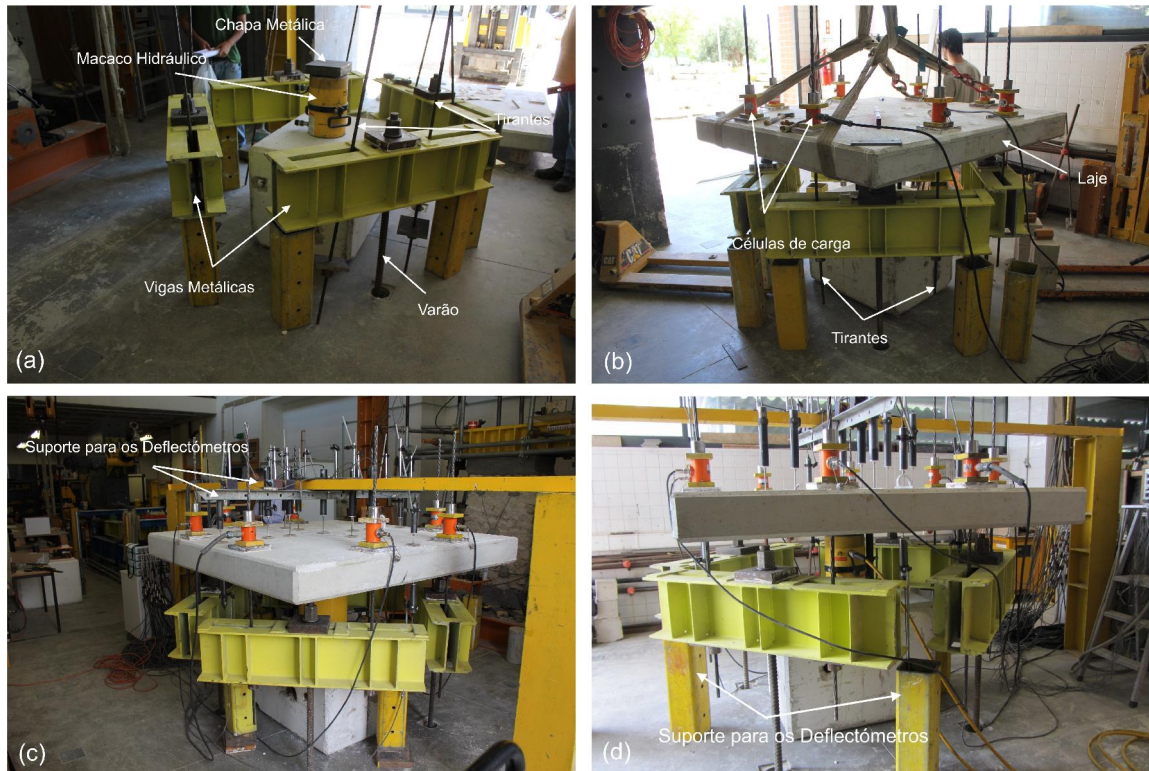
Figura 3.19: Montagem do sistema de ensaio.
