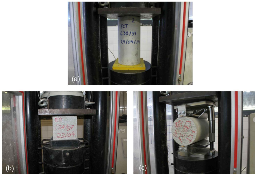
Figura 3.14: Fotografias dos ensaios de caracterização do betão: (a) Ensaio de compressão em provete cúbico; (b) Ensaio de compressão em provete cilíndrico; (c) Ensaio de compressão diametral em provete cilíndrico.
