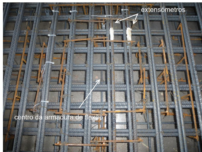
Figura 3.25: Fotografia da localização dos extensômetros na armadura de flexão da laje PBC2.
