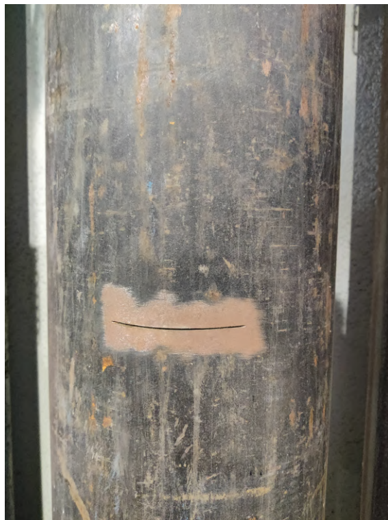
Figura 2.9: Defeito infligido por ação de corte
