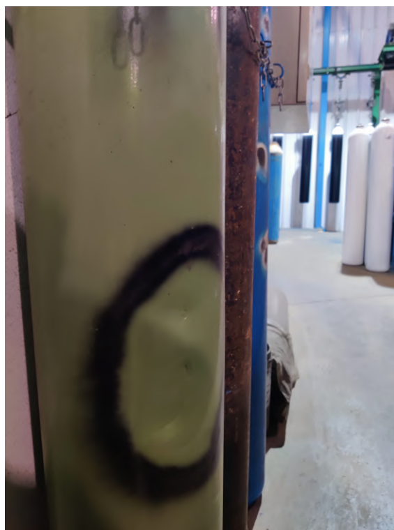
Figura 2.10: Defeito infligido por ação de impacto mecânico
