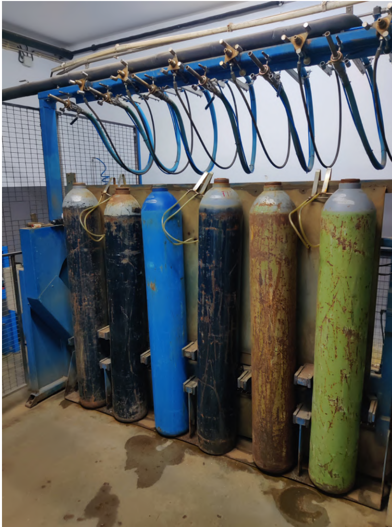
Figura 2.13: Banco de prova com 6 garrafas
