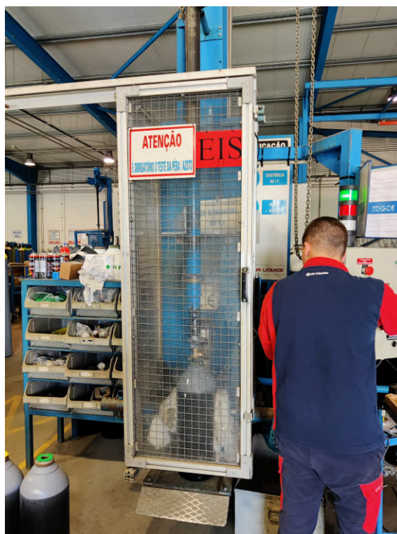
Figura 2.21: Montagem da válvula numa garrafa de 20 litros
