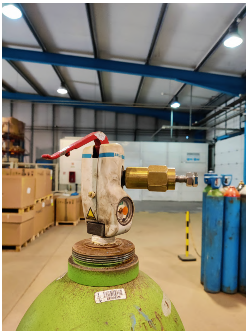
Figura 2.11: Retirada da pressão residual de uma garrafa
