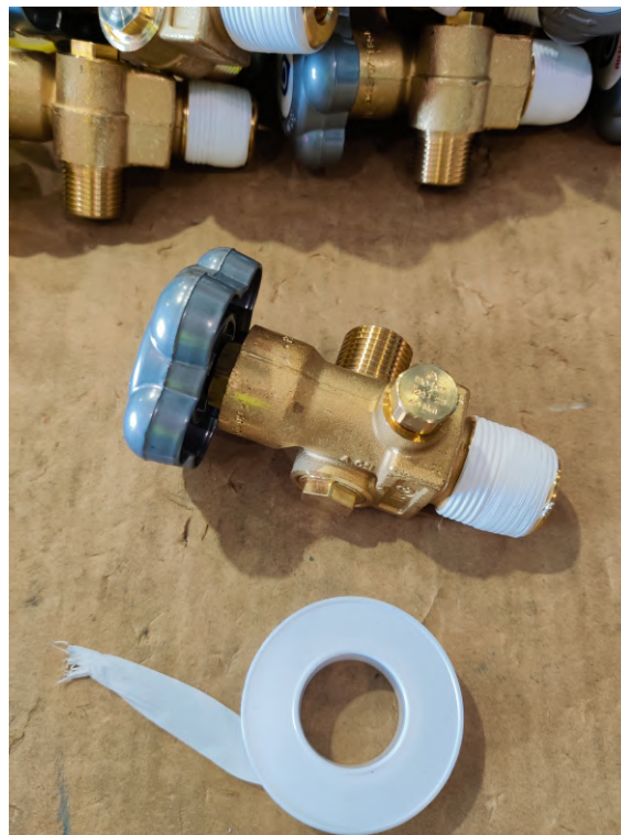
Figura 2.20: Válvula com teflon aplicado
