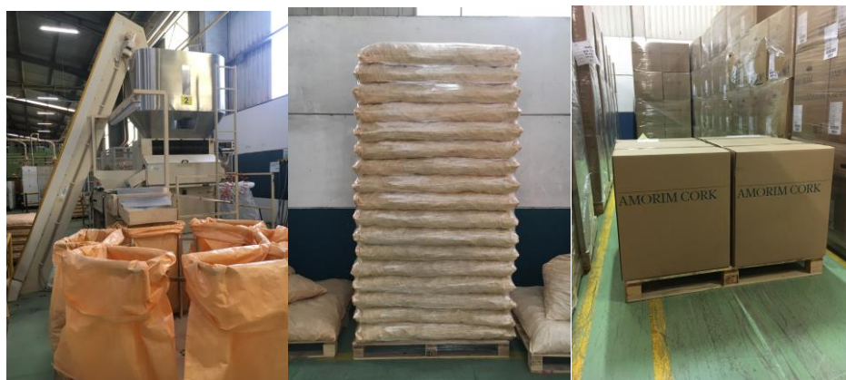
Figura 2.13 - Contagem e embalagem - TT (A); Embalagem em sacas (B) ou em caixas (C)
