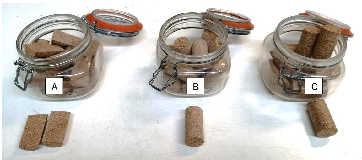
Figura 4.3 - Soaks de grupo com corpos partidos (A), com corpos retificados (B) e com corpos em bruto (C)
