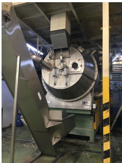
Figura 2.8 - Máquina de Lavação – AGLO
