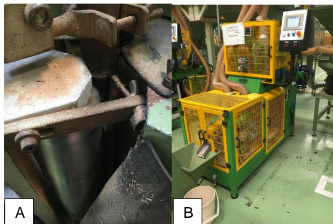
Figura 2.6 - Mecanismo de ponçamento (A); Retificadora - TT (B)
