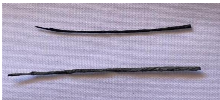
Figura 3.15 – Imagem macroscópica de um fio de AC/PPy (em baixo) e PCL/PPy (em cima)
