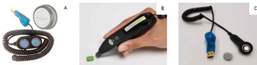
Figura 3.1: Dispositivos de monitorização da adesão através de sensores de temperatura. A: iButton®. Adaptado de [60]. B: Orthotimer®. Adaptado de [61]. C: stTracker®. Adaptado de [62].
