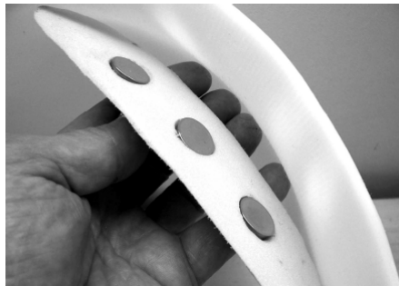
Figura 3.2: Três sensores que medem a temperatura e o tempo e que foram incorporados numa almofada, que podia ser lombar, torácica, trocantérica ou de cintura, de uma ortótese toracolombosacral. Adaptado de [6].
