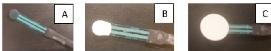
Figura 5.7: Sensor de pressão sem nenhum material colado na zona posterior da área ativa (A), com um material (plástico semiduro) colado com o formato da área ativa (B) e com o mesmo material, com o formato de uma circunferência (C).
