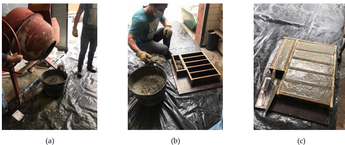
Figura 3.2. Betoneira despejando o betão dentro do recipiente (a); moldagem dos provetes (b); e moldes preenchidos (c)
