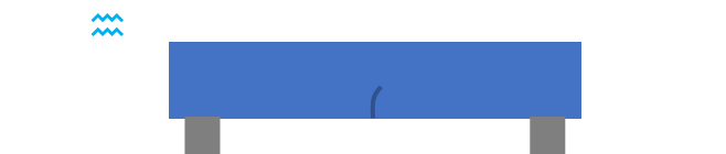
Figura 3.4. Condição esquemática de imersão dos provetes fendilhados em água para a cura
