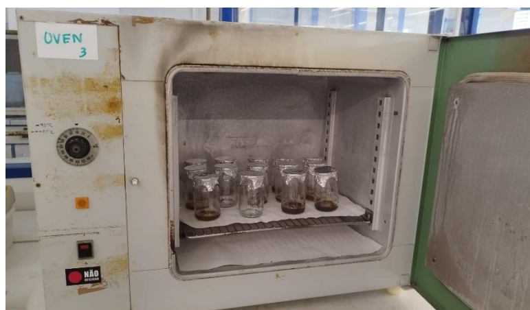
Figura 2.4 - Amostras de mexilhão na estufa durante o processo de digestão, a 40°C.
