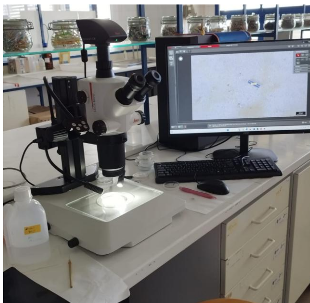
Figura 2.6 - Lupa estereomicroscópica Leica® S ApoE
