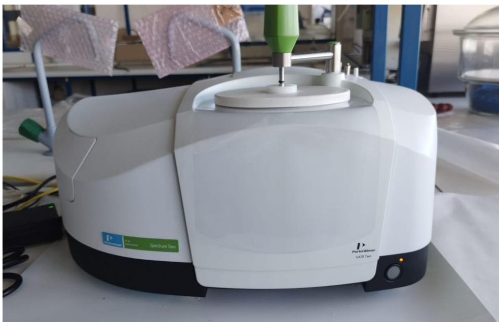
Figura 2.7 - Equipamento utilizado para análise FT-IR.
