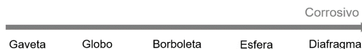
Figura 2.5: Regra geral para a seleção de válvulas consoante a natureza do fluido. Adaptado de [23].
