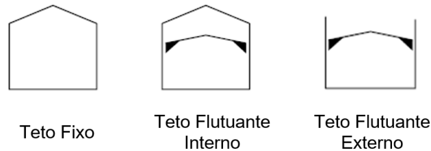
Figura 2.3: Tipos de tetos de tanques de armazenamento. Adaptado de [23].
