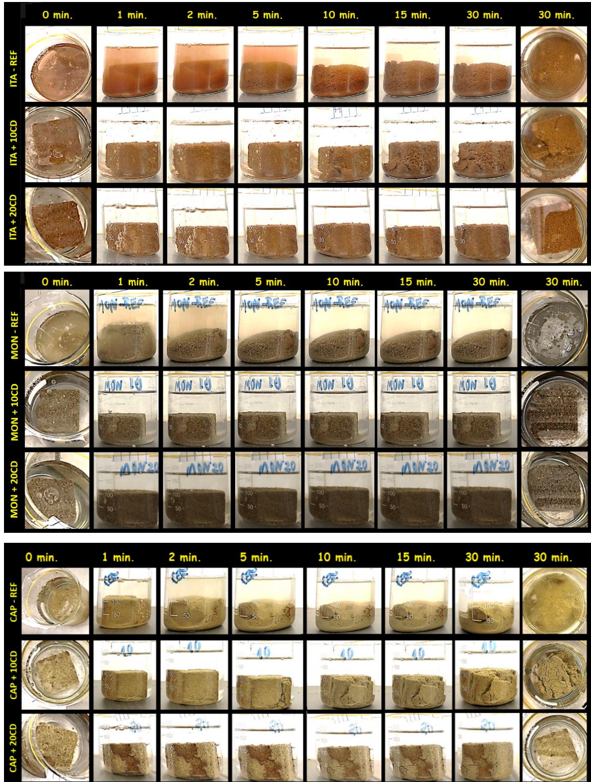
Figura 3. Corpos de provas das argamassas com terra (ITA, MON e CAP respectivamente) com 0%, 10% e 20% de EB em imersão em água até 30 minutos.
