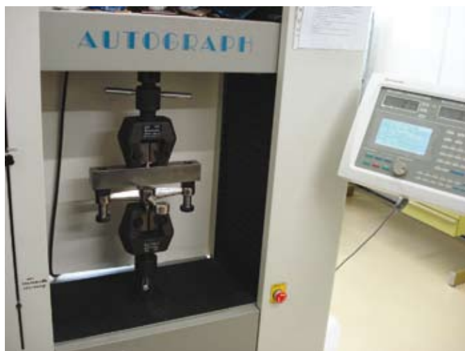
↳ Ensaios de resistência mecânica. Mechanical destructive tests.
