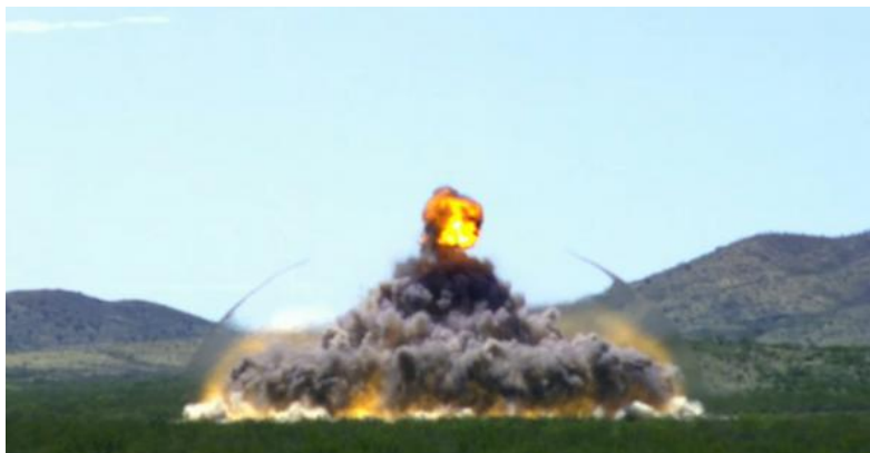
Fig. 3.1: Onda de choque causada por uma explosão (adaptada de [13])
