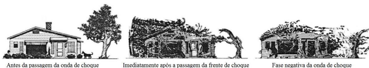
Fig. 3.2: Fases de uma onda de choque (adaptada de [36])
