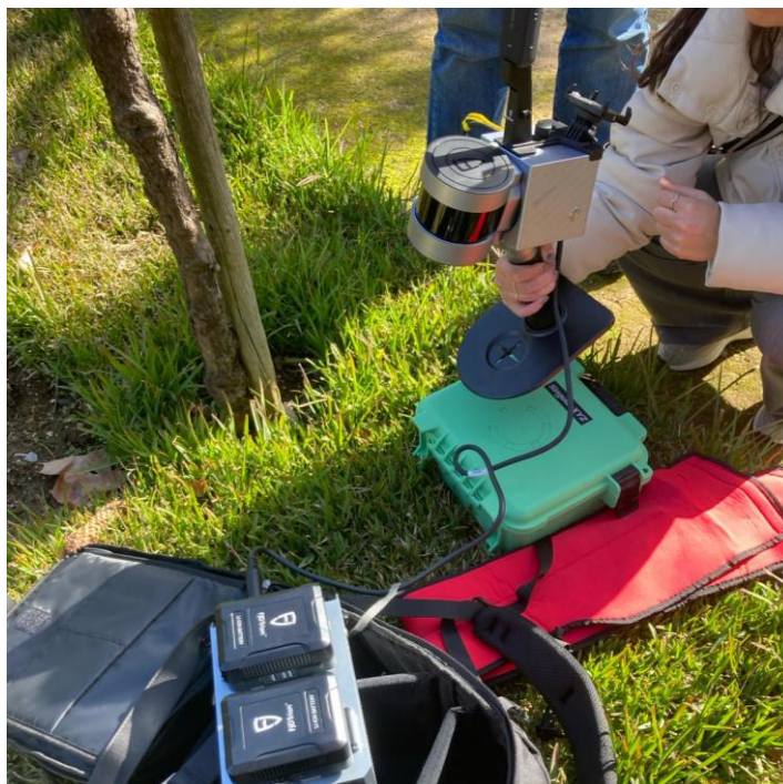
Figura 2.10- Fotografia de uma sessão de demonstração da tecnologia Mobile Laser Scanning (MLS)
