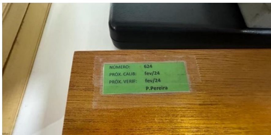
Figura 9 - etiqueta de verificação da ferramenta de medição
