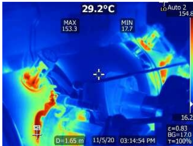
Figura 54 – Imagem termográfica da máquina a vapor em funcionamento
