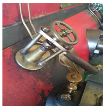
Figura 22 - Fotografia da válvula manual
