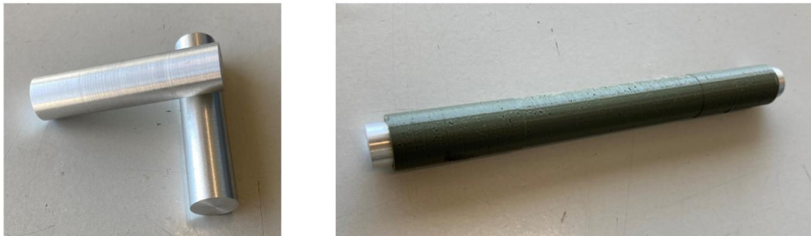
Figura 7.3 Varões de alumínio para as extremidades dos provetes
