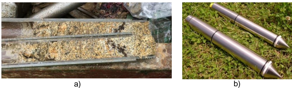
Figura 2 – Exemplos de dois equipamentos para a avaliação das características do terreno: a) Amostrador SPT de duas meias canas com amostra de solo recolhida (SINERGEO, 2021); b) Piezocone (Gouda Geo, sem data)
