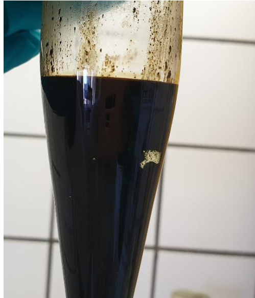
Figura 4.1 – Resultado da centrifugação: t=30 min; T=\text{ambiente} ; r= 3000 rpm
