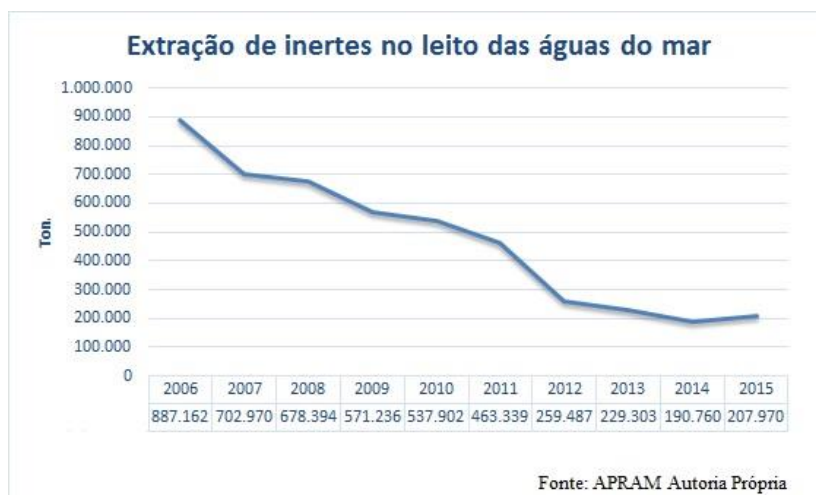
Figura 28 – Extração de inertes no leito das águas do mar. Fonte: APRAM.
