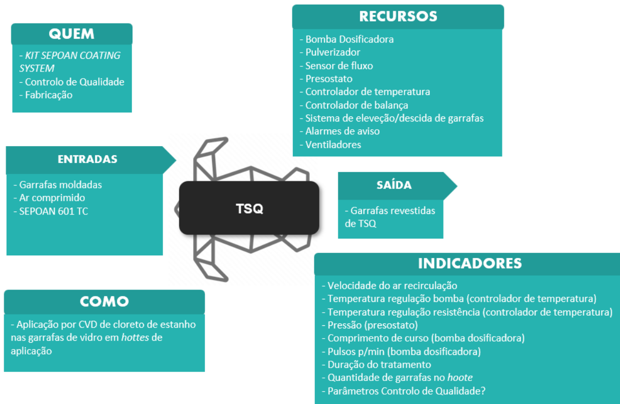
Figura 3.26 - Processo de deposição de TSQ
