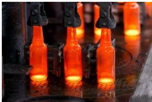
Figura 3.9 - Formação de garrafas numa máquina IS de gota tripla [90]
