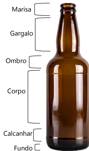
Figura 3.1 - Nomenclatura das zonas de uma garrafa de vidro
