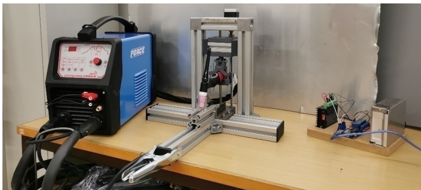
Figura 3.1. Montagem Experimental do aparelho de soldadura TIG
