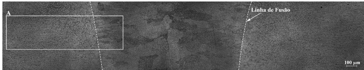
Figura 4.3. Microestrutura do cordão produzido na liga Ni_{50}Ti_{35}Fe_{15}
