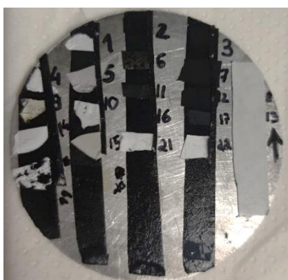
Figura 4.5 - Porta-amostras com as amostras preparadas e identificadas para o SEM.
