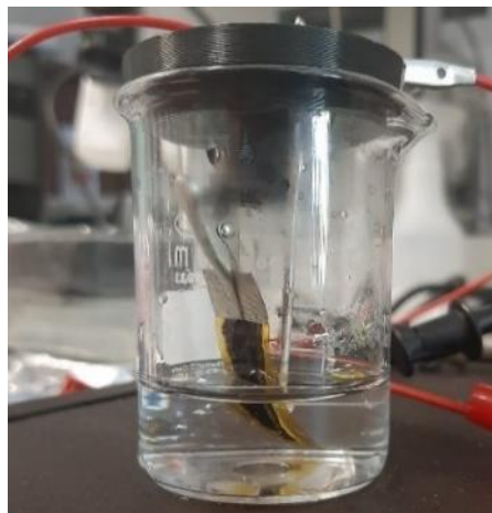
Figura 4.9 - Montagem experimental adotada nos testes de libertação. À esquerda, elétrodo positivo em contacto com o sistema de membranas, à direita contra-elétrodo de prata.
